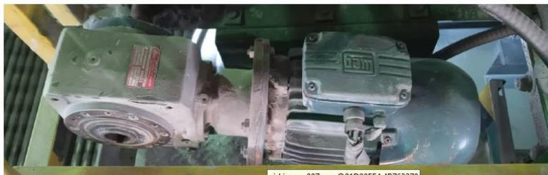
Esse projeto consiste na compra de motorreductores para instalação nas válvulas rotativas de alimentação e descarga do aeroclassificador, com o objetivo de nacionalizar o equipamento.
