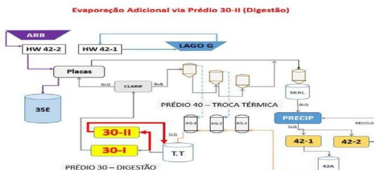
O projeto consiste em reciclar o licor usado no tanque do material do processo produtivo (TT), adaptando as tubulações existentes para aumentar a capacidade do sistema de diluição do tanque de água causticada (WW) para o Lavador 3 (separa a soda da lama de bauxita).
