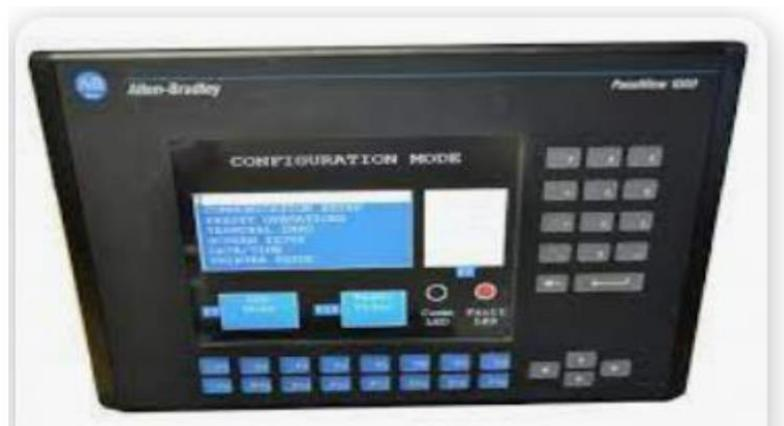
O projeto consiste na aquisição de um PanelView 1000 da Rockwell Automation para que a engenharia local de automação industrial desenvolva o sistema de supervisão e controle backup do Prédio 35-X. Visa evitar falta de energia na área, impactando o controle e supervisão do processo, conforme ocorreu no início de 2014.
