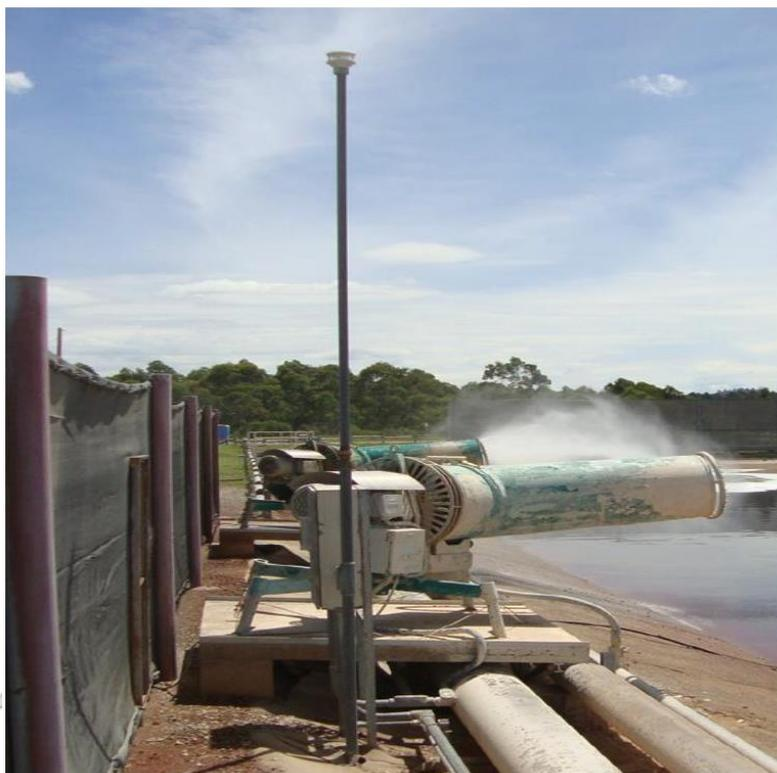
O projeto visa montar um sistema de evaporadores, onde o licor do lago 2 será bombeado para dutos direcionados aos ventiladores com bicos aspersores, para que a água seja transformada em pequenas partículas, evaporando-se, e o licor retorne para a produção.
