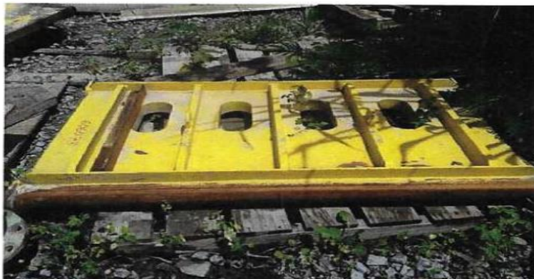
Abanadeira, peça componente do Britador de Mandíbulas
