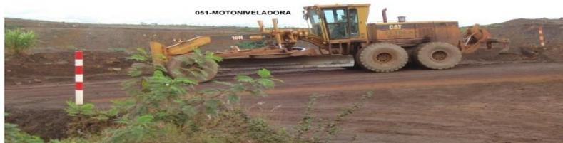
DENTRO DE UMA MINA HÁ ESTRADAS E/OU VIAS QUE INTERLIGAM OS DIVERSOS SETORES. AS MOTONIVELADORAS SÃO RESPONSÁVEIS PELA ABERTURA E CONSERVAÇÃO DESSAS VIAS (TERRAPLANAGEM - APOIO OPERACIONAL), MAS NÃO DESEMPENHAM NENHUMA AÇÃO NO PROCESSO DE MINERAÇÃO PROPRIAMENTE DITO.
