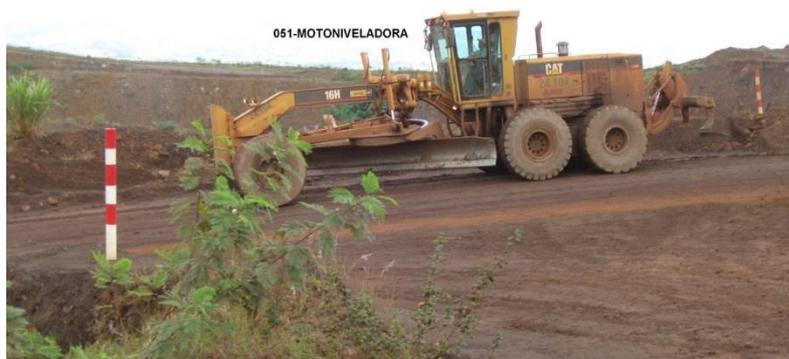
DENTRO DE UMA MINA HÁ ESTRADAS E/OU VIAS QUE INTERLIGAM OS DIVERSOS SETORES. AS MOTONIVELADORAS SÃO RESPONSÁVEIS PELA ABERTURA E CONSERVAÇÃO DESSAS VIAS (TERRAPLANAGEM - APOIO OPERACIONAL), MAS NÃO DESEMPENHAM NENHUMA AÇÃO NO PROCESSO DE MINERAÇÃO PROPRIAMENTE DITO.
