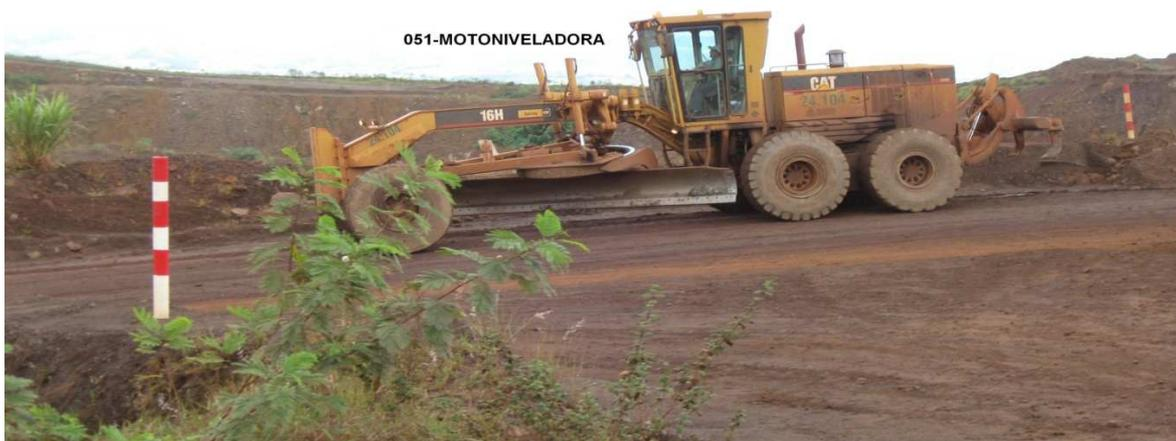
Dentro de uma mina há estradas e/ou vias que interligam os diversos setores. As motoniveladoras são responsáveis pela abertura e conservação dessas vias (terraplanagem - apoio operacional), mas não desempenham nenhuma ação no processo de mineração propriamente dito.
